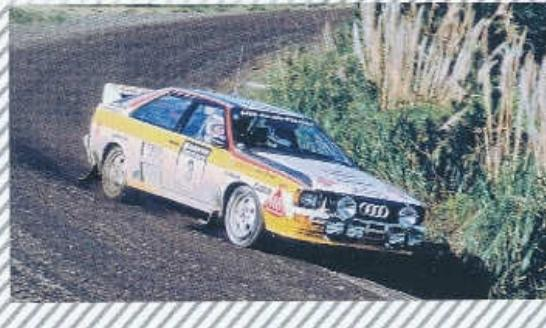
mělo z kevlaru. Poháněl je pětiválec 2133 cm<sup>3</sup> s dvacetiventilovou hlavou a rozvodem DOHC, jenž díky novému turbodmychadlu dával v silniční verzi výkon 306 k (225 kW). Vůz o hmotnosti 1300 kg dosahoval na pneumatikách 235/45 VR 15 největší rychlosti 250 km/h a sprint z 0 na 100 km/h zvládl za necelých 5 s.
