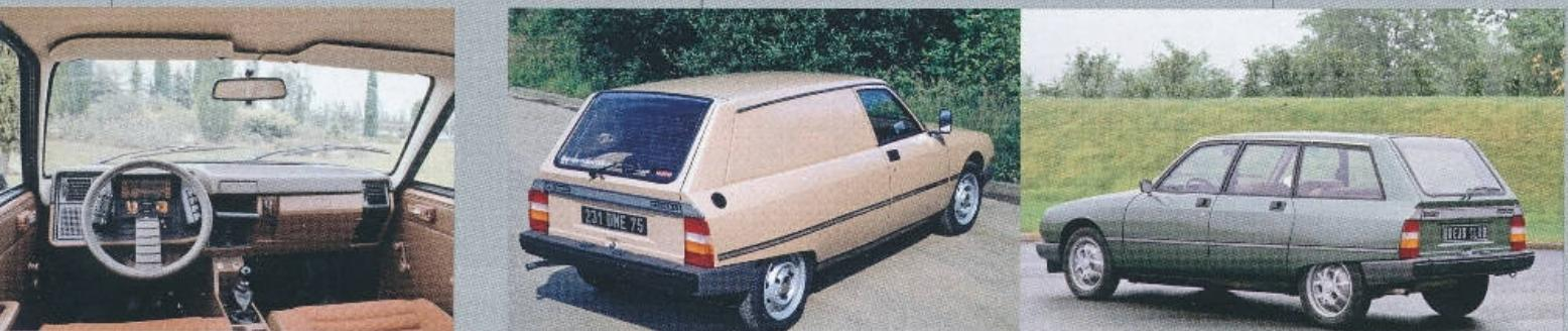
řešení zadní stěny karoserie, jež se vyklápěla vzhůru spolu se středním dílem nárazníku.
