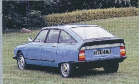
> V září 1973 slavil premiéru na frankfurtském autosalonu Citroën GS Birotor, jehož přední kola poháněl napříč uložený kapalinou chlazený dvoukomorový motor Wankel s krouživými pisty. Z objemu  $2 \times 497,5 \text{ cm}^3$  dával výkon 107 k (79 kW) a byl spojen s třístupňovou poloautomatickou prevodovkou, takže se obešel bez spojkového pedálu.
