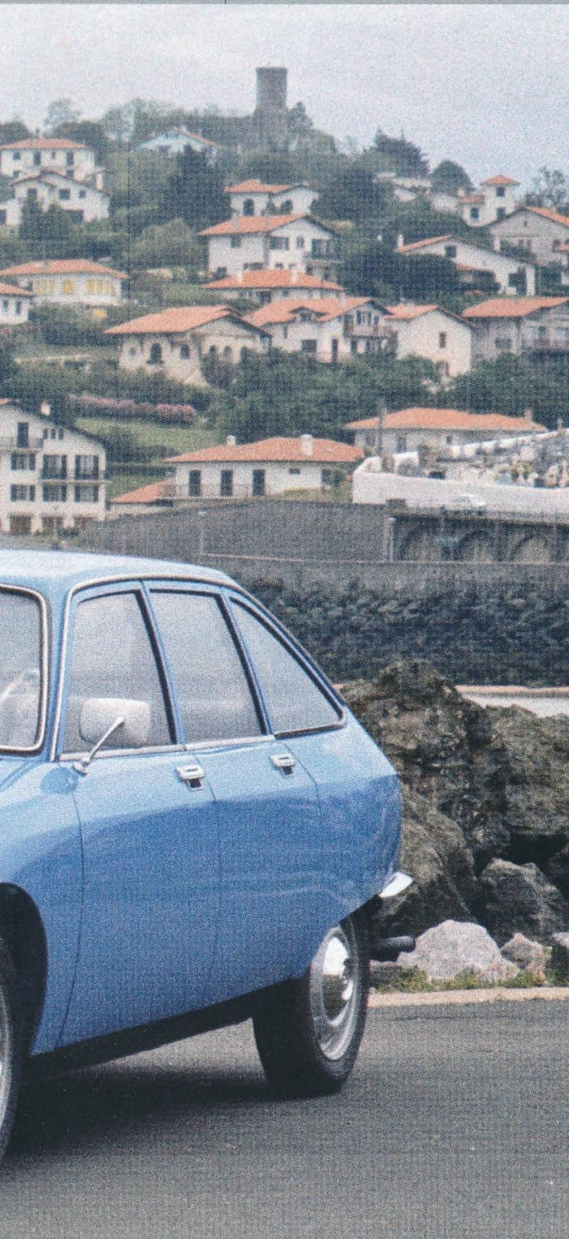
Letos v září slaví padesátiny Citroën GS, elegantní vůz nižší střední třídy, jehož přední kola poháněl vzduchem chlazený plochý čtyřválec. Jako jediný ve své třídě se mohl pochlubit plynokapalinovým odpružením a vysokotlakým ovládáním brzd.
