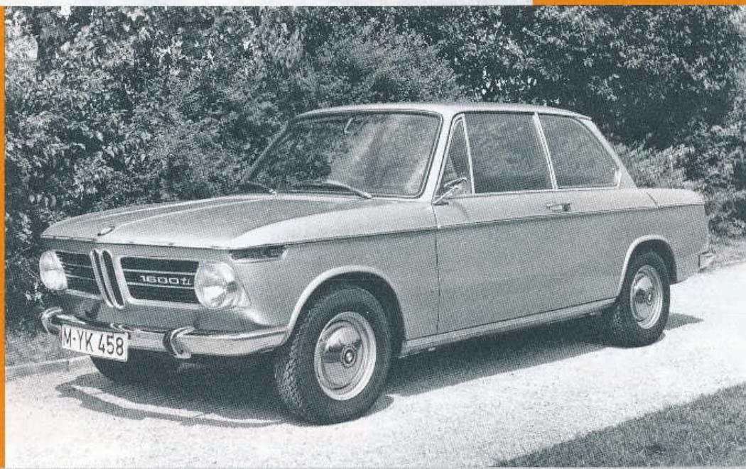
► Dvoudveřový vůz, jenž nesl na zádi zkrácené označení BMW 1600, měl pod kapotou řadový čtyřválec OHC o objemu 1 573 cm<sup>3</sup> a výkonu 85 k (63 kW) při 5 700 1/min spojený s plně synchronizovanou čtyřstupňovou převodovkou. Elektrická soustava pracovala zpočátku s napětím 6 V, až od září 1967 vůz dostal alternátor a elektroinstalaci 12 V.
