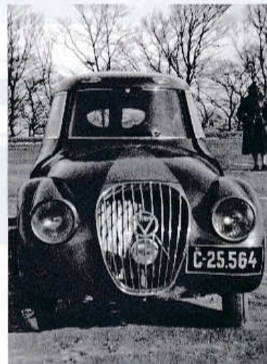
Osobitě tvarovaná příď prototypu FRM se směrovkami nad čelním sklem
