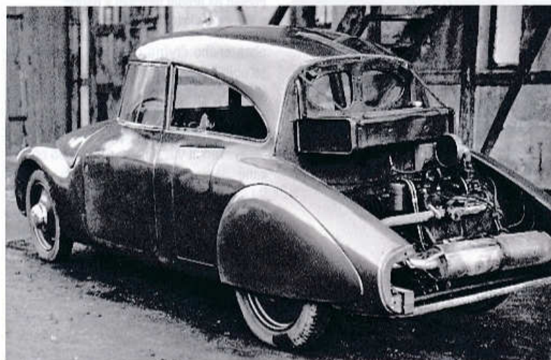
Zád' vozu bez kapoty a zadního čela, nádrž byla zavěšena na dělicí stěně
