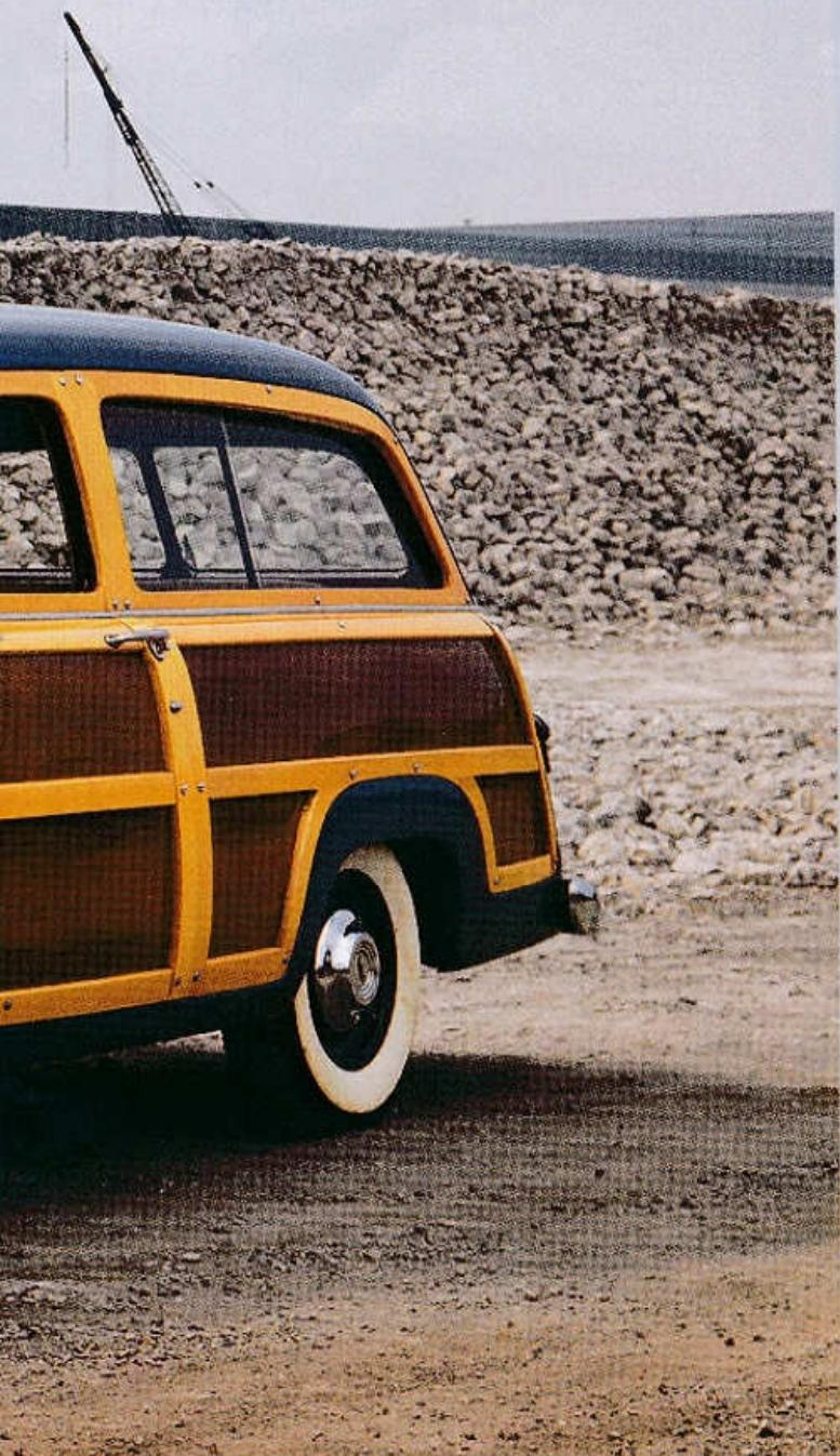
STW s rozvorem 2,9 m a pětimetrovou délkou se dodávalo s řadovým šestiválcem 3,7 l o výkonu 90 k (66 kW), nebo s motorem V8 3,9 l, který dával 100 k (74 kW). Oba motory byly spojeny s třistupňovou manuální převodovkou. Klasickou koncepcí s poháněnou tuhou zadní nápravou snad ani nemusíme připomínat.
