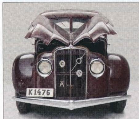
Přístup k šestiválci o objemu 3,7 l a výkonu 80 k (59 kW) otvírá dvoukřídlá kapota
