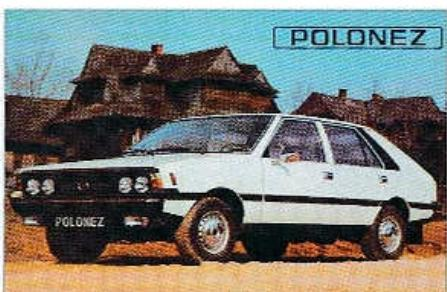
vysoký 1420 mm (v zatíženém 1379 mm). Vykazoval hmotnost 1140 kg, jeho užitečná hmotnost měla hodnotu 400 kg, podle výrobce mohl přepravovat pět osob a 50 kg zavazadel.
