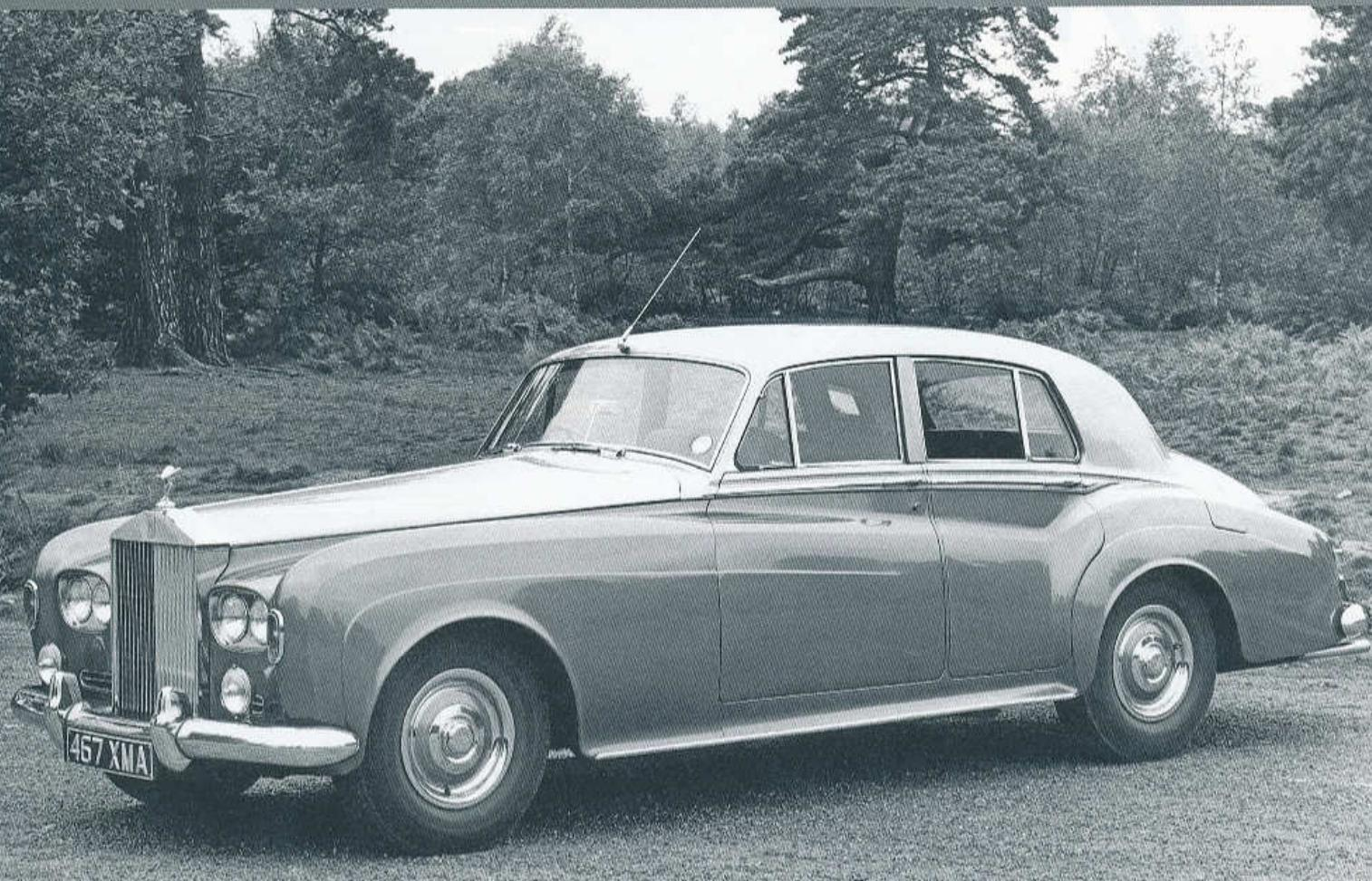
chladiče byla snížena o 1,5 palce (38 mm) stejně jako kapota. Osmiválec 6 230 cm<sup>3</sup> se zvýšeným stupněm komprese údajně dával kolem 200 k (147 kW) a spolu se čtyřstupňovou samočinnou převodovkou vozu umožňoval překonat hranici 180 km/h.
