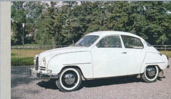
Saab 96 s dvoudobým tríválcem 841 cm<sup>3</sup> v prvním provedení z roku 1960
