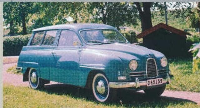
Od podzimu 1964 měly vozy Saab 96 a 95 delší příd'a chladič před motorem
