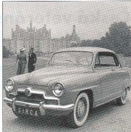
Prototyp dvoudveřového vozu Aronde Grand Large bez středních sloupků (1952)
