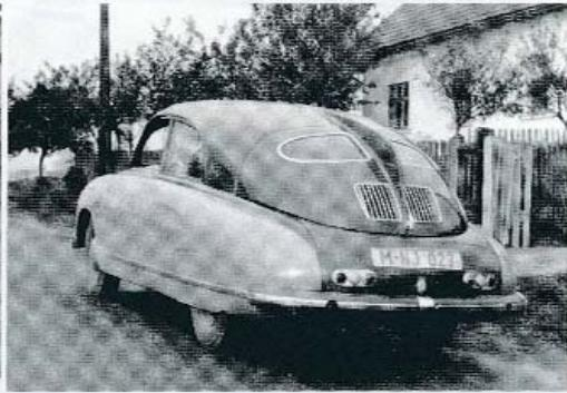
▲ Záď kupé s motorem V8 zdobily rozmněné mřížky větrání
