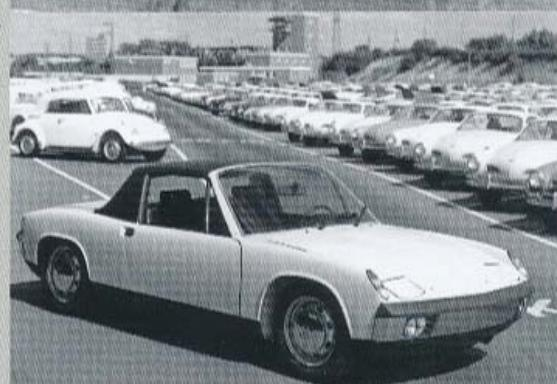
Model 914 vybavený čtyřválcem OHV z modelu VW 411 E o objemu 1,7 l a výkonu 80 k (59 kW) spojený s pětistupňovou manuální převodovkou vykazoval hmotnost 940 kg a na patnáctipalcových kolech dosahoval největší rychlosti 177 km/h. Počátkem roku 1970 se do něj začala alternativně montovat čtyřstupňová poloautomatická převodovka Sportomatic s dvoupedálovým ovládáním, jež zvýšila hmotnost vozu o 15 kg a snížila jeho maximální rychlosť na 172 km/h.
