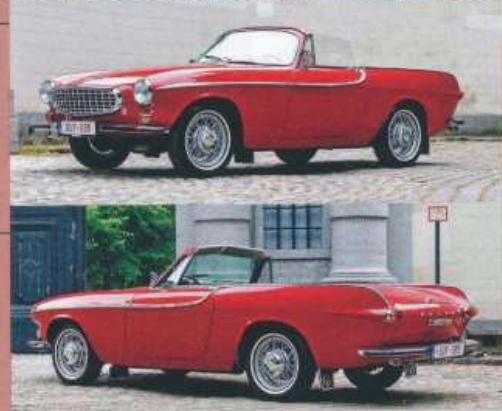
Od léta 1968 mělo Volvo 1800 S pod kapotou větší čtyřválec 1986 cm<sup>3</sup> o výkonu 105 k (77 kW), dostalo dvouokruhovou brzdovou soustavu, jejíž každý okruh propojoval kotoučové brzdy obou předních kol a jednu zadní bubnovou brzdu. Standardním obutím kupé se staly radiální pneumatiky 165 HR 15. V zimě 1968–69 byly lisovací nástroje karosářských dilů přesunuty ze Skotska do závodu Volvo v Olofströmu v jižním Švédsku.
