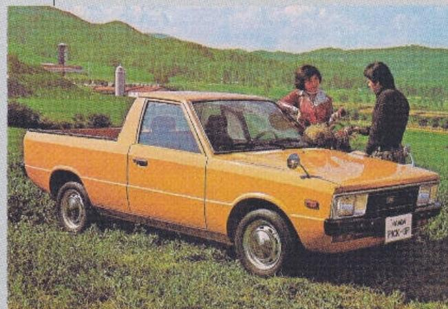
Brzdy byly vpředu kotoučové a vzadu bubnové s dvouokruhovým ovládáním, třináctipalcová kola nesla pneumatiky 6,15–13 nebo 155 SR 13. Řízení s oběžnými kuličkami mělo výškově seřiditelný bezpečnostní hřidel volantu.
