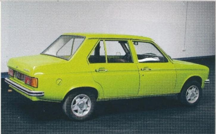
› Zavazadlový prostor v zadní přístupný nevelkým víkem zavěšeným pod spodním okrajem zadního okna kabiny měl využitelný objem 228 l, do palivové nádrže umístěné pod podlahou zavazadleníku mezi zadními koly se vešlo 40 l benzínu.
