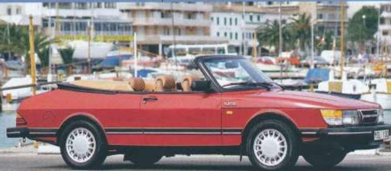
» V obou případech byl spojen se čtyřstupňovou manuální převodovkou, model GLS však mohl za příplatek dostat i třístupňovou automatiku Borg-Warner. Vozy o hmotnosti 1200 až 1250 kg dosahovaly rychlosti 165 a 170 km/h a spotřebovaly 10 až 11 l benzínu na 100 km.
