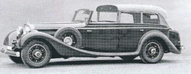
Kariéra automobilů Mercedes-Benz 770 řady W 07 skončila v roce 1938, štafetu převzaly vozy řady W 150 nesoucí opět typové označení 770. Poháněl je osvědčený osmiválec 7,7 l s lehce zvýšeným výkonem, dostaly však zcela nový podvozek s nezávislým zavěšením předních kol a zadní nápravou De Dion, v obou případech s pěrováním vinutými pružinami. <
