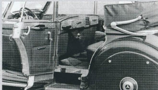
Interiér kabrioletu s dělící stěnou za řidičem
