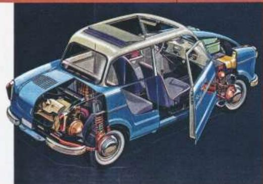
dvouválec OHC o objemu  $583 \text{ cm}^3$  a výkonu 20 k (15 kW) spojený se čtyřstupňovou převodovkou. Motor a převodovka měly společnou olejovou náplň, chlazení podporoval ventilátor. Elektroinstalace pracovala s napětím 12 V.
