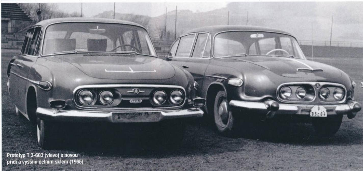
Prototyp T 3-603 (vlevo) s novou přídí a vyšším čelním sklem (1965)
