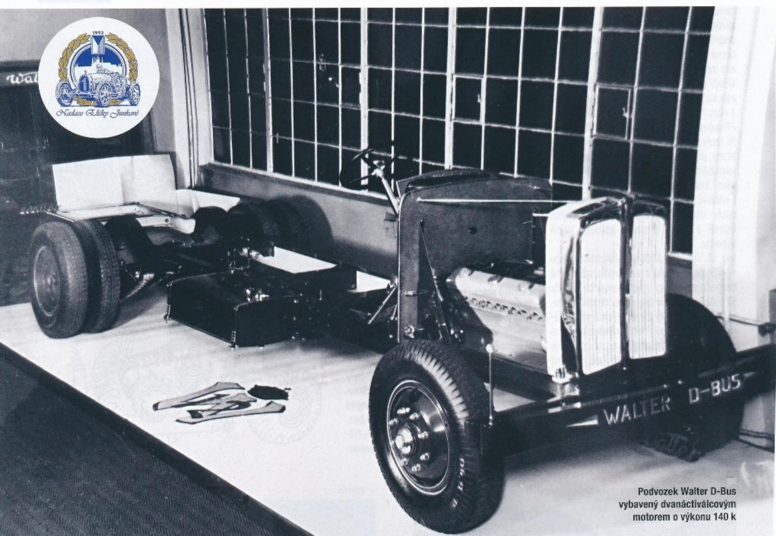
Podvozek Walter D-Bus vybavený dvanáctiválcovým motorem o výkonu 140 k
