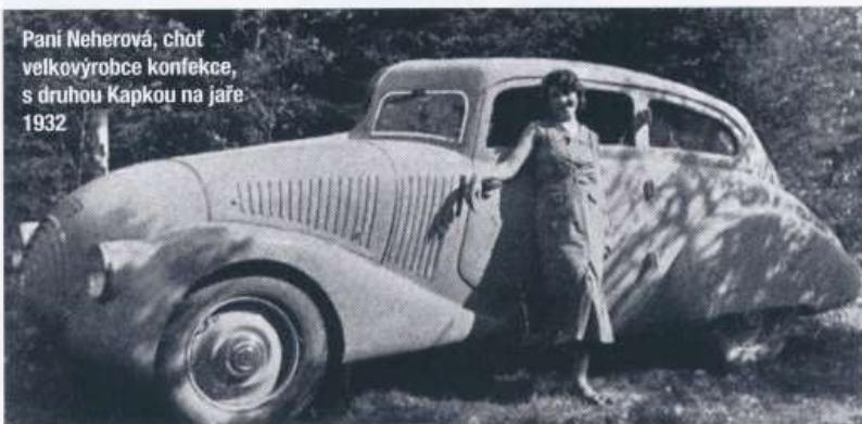
mický Wikov 35 s třímetrovým rozvorem náprav a rozchodem kol 1,28 m vpředu i vzadu byl podle dobových nákresů dlouhý 4,90 m, široký 1,55 m a vysoký 1,60 m. Jeho hmotnost zřejmě převyšovala 1400 kg, takže sice dosahoval největší rychlosti přes 100 km/h, ale hospodárnější než sériový uzavřený vůz nebyl.
