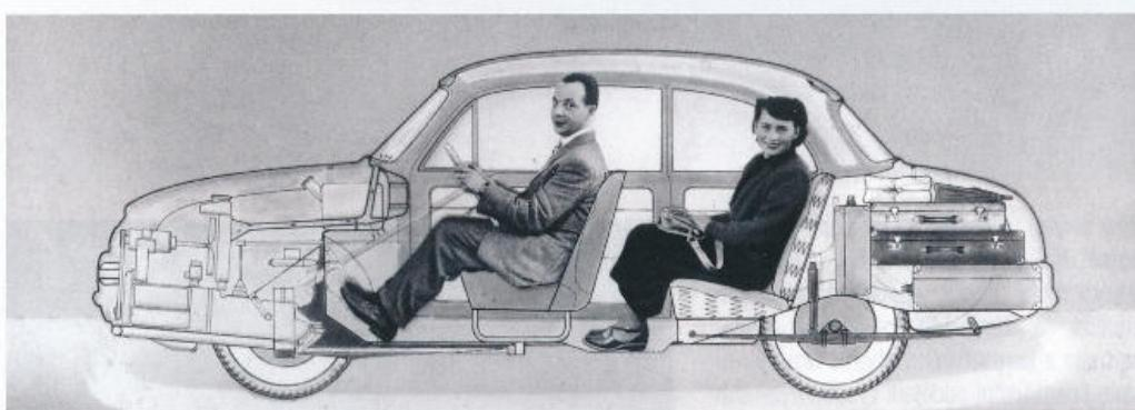
Poháněná přední kola byla zavěšena na dvojicích přičních rámů odpružených podélnými zkrutnými tyčemi. Hřebenové řízení opatřené pružným pryžovým kloubem mělo krátké spojovací tyče umístěné za
