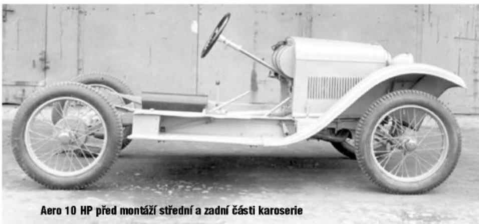
Aero 10 HP před montáží střední a zadní části karoserie
