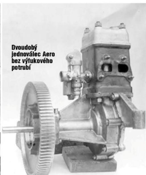
Dvoudobý jednoválec Aero bez výfukového potrubí
