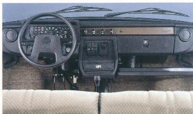
**Palubní deska s novým sdruženým přístrojem se montovala od léta 1987**
