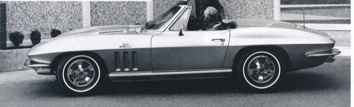
1965 dostala Corvette kotoučové brzdy na všechna čtyři kola, širší rozchod kol a větší pneumatiky 7,75 – 15. Těžiště kupé bylo jen 450mm nad vozovkou, na úrovni řídicových kolen. V modelovém roce 1966 rozšířil nabídku motor Turbo-Jet 427, atmosférický karburátorový V8 o objemu 7,0l. Ve špičkové verzi dával 425k (313kW), v mírnější 390k (287kW).
