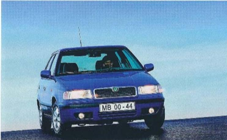
Vozy vybavené motory 1,6 MPI a 1,9 D dostaly standardně příčný zkrutný stabilizátor přední nápravy a posilovač řízení, za příplatek nabízené protiblokovací zařízení ABS bylo nového typu.
