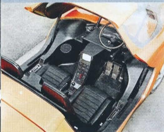
Interiér kupé Hurricane, volant se odklápal spolu s krytem kabiny
