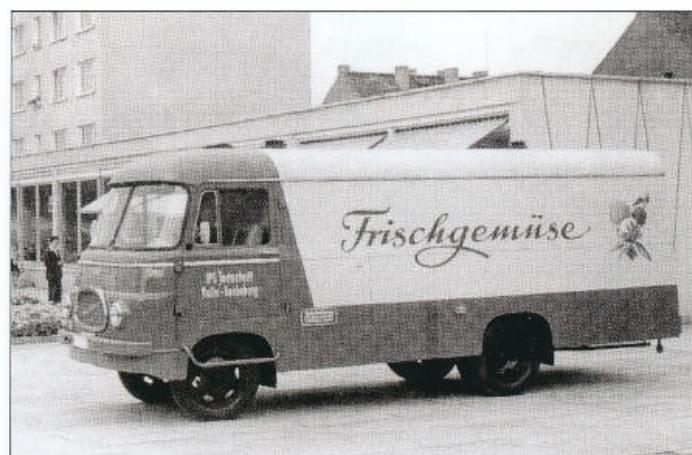
Robur LO 2500 se skříňovou karoserií o objemu 15 m<sup>3</sup> a vnitřní výškou 1,68 m
