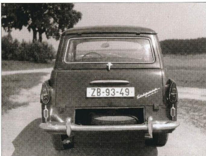
Náhradní kolo se dalo vyjmout po spuštění obdélníkového krytu
