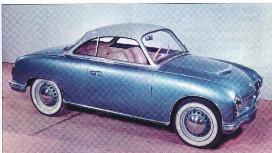
Od jara 1957 vyráběná kupé P 70 mělo kapotu a střechu z ocelového plechu
