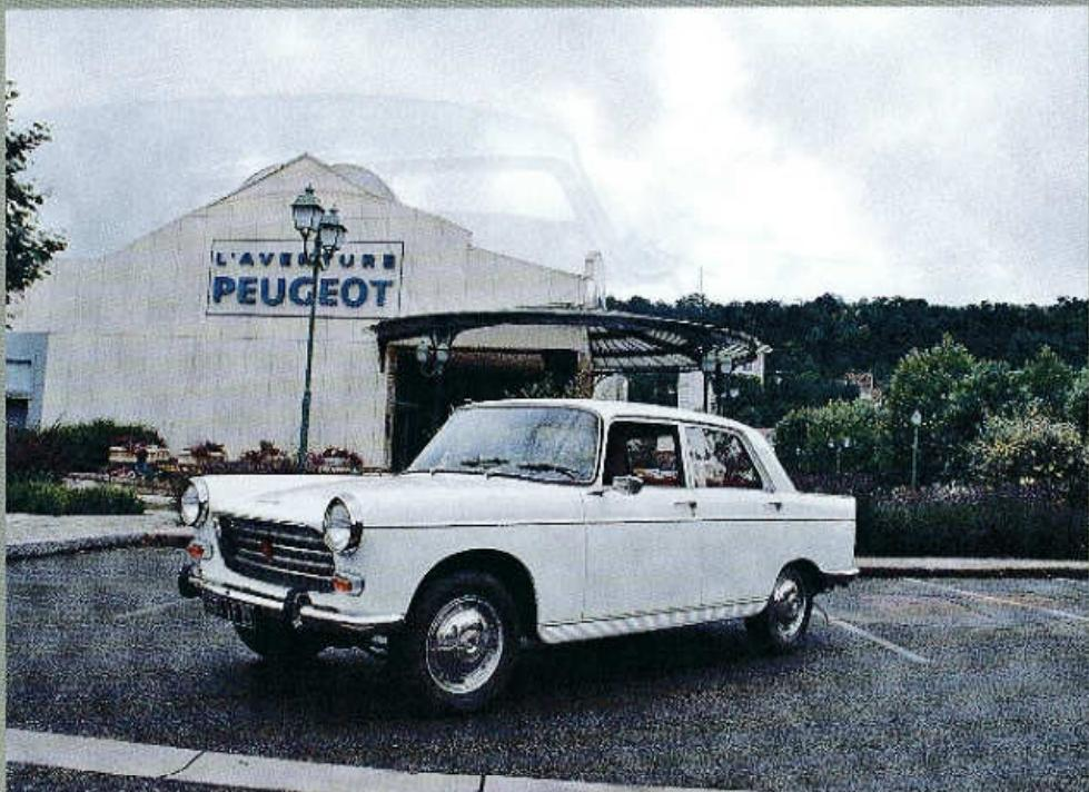
vysoký 1450 mm a vykazoval pohotovostní hmotnost 1070 kg. Pod samonosnou karoserií se skrýval na svoji dobu moderní podvozek – vpředu závěsy McPherson s vinutými pružinami, vzadu poháněná tuhá náprava ustanovená panhardskou tyčí a odpérovaná vinutými pružinami. Sedan vybavený zážehovým čtyřválcem 1618 cm<sup>3</sup> o výkonu 72 k (53 kW) spojeným se čtyřstupňovou převodovkou dosahoval na patnáctipalcových kolech největší rychlosti přes 140 km/h a spotřeboval 8 až 10 l benzínu na 100 km.
