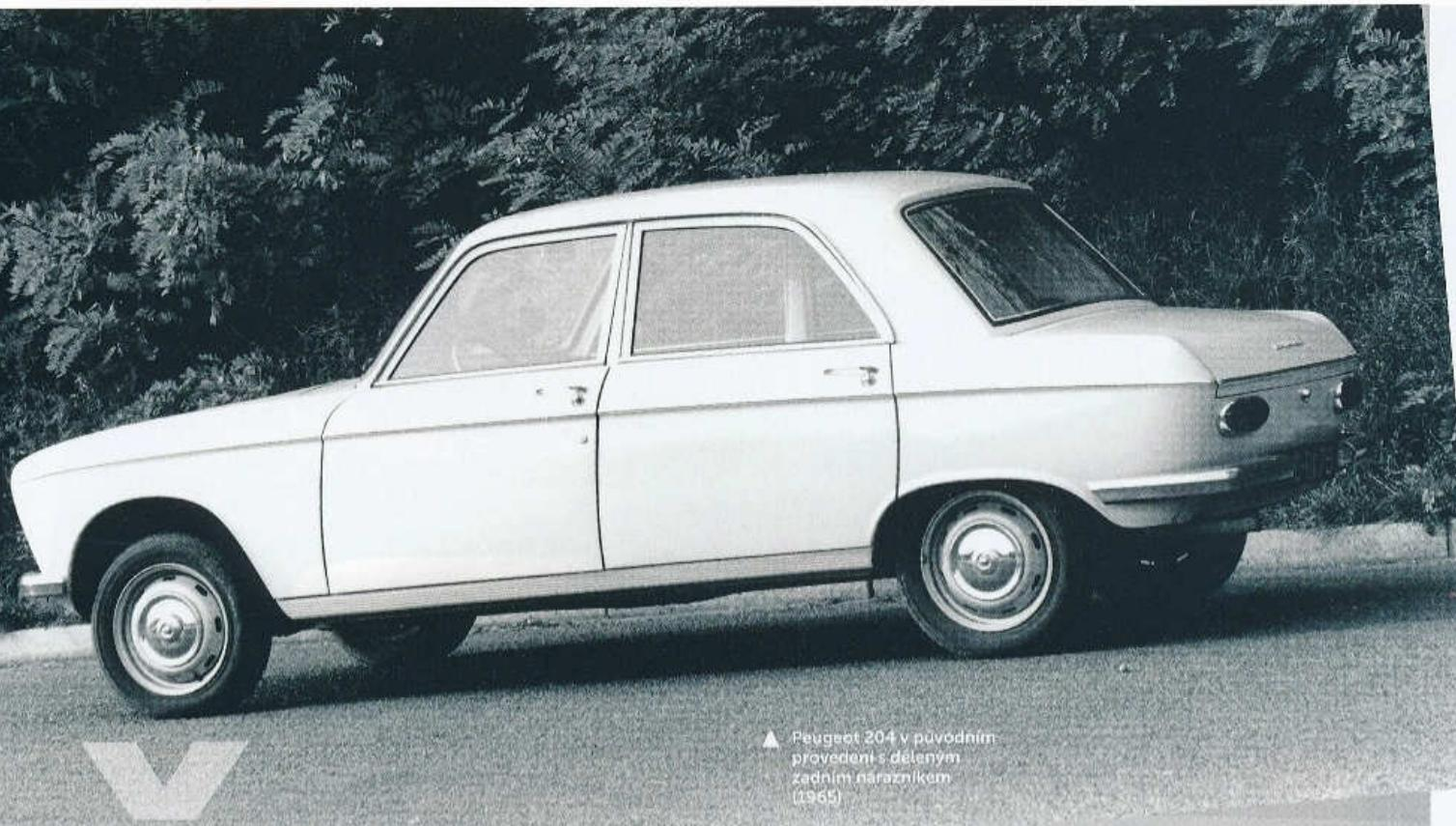
▲ Peugeot 204 v původním provedení s děleným zadním nárazníkem (1965)
