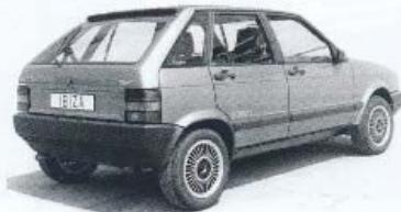
Ibiza měla všechna čtyři kola zavěšena nezávisle, vpředu odpružena vinutými pružinami, vzadu příčními zkrutnými tyčemi. Brzdy byly vpředu kotoučové a vzadu bubnové, s posilovačem, řízení hřebenové. Hmotnost vozu se pohybovala kolem 800 kg.
