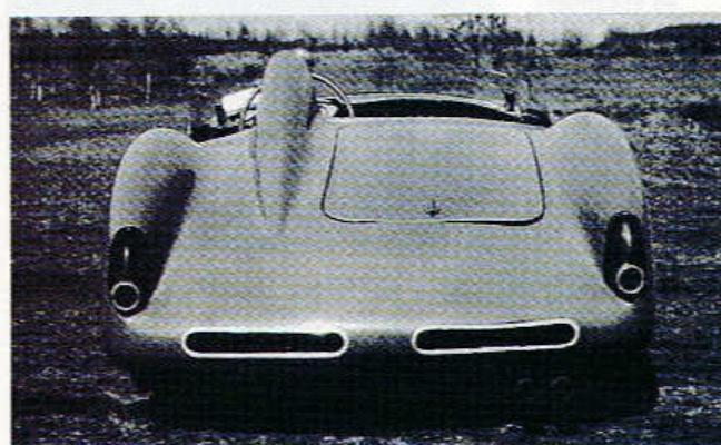
Záď otevřeného vozu s výkem umožňujícím přístup k náhradnímu kolu.
