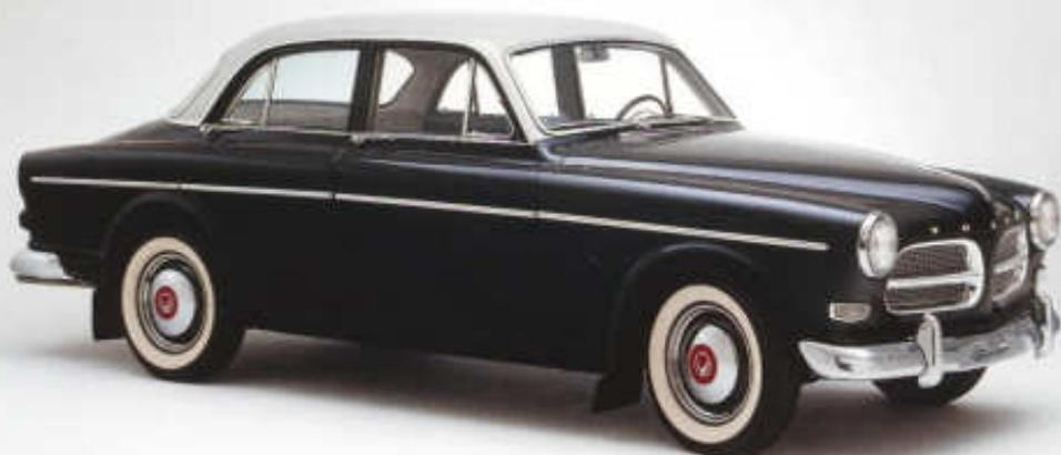
převodovkou ovládanou řadící pákou na středním tunelu. Tento vůz už jezdil přes 150 km/h. V sezóně 1959 se firma Volvo stala první automobilkou na světě, jež začala přední sedadla svých vozů standardně vybavovat třibodovými bezpečnostními pásy.
