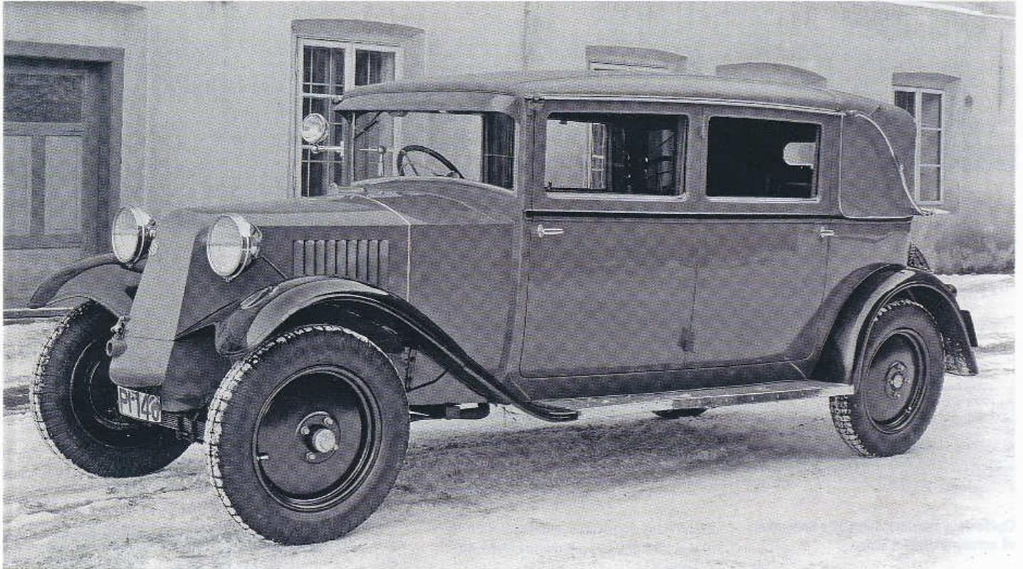
rem 2770 mm. Přední náprava byla tuhá, odpružená příčným listovým perem a opatřená olejovými tlumiči, poháněná zadní kola nesly výkyvné polonápravy odpružené příčným listovým perem. Kompletní podvozek „dvaapadesátky“ se světloú výškou 220 mm vykazoval hmotnost těsně pod hranicí 600 kg.
