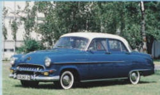
ral měl ještě samostatný rám podvozku, nezávisle zavěšení předních kol s vinutými pružinami a poháněnou tuhou zadní nápravu, odpruženou podélnými listovými pery. Bubnové brzdy na všech čtyřech kolech měly kapalinové ovládání.
