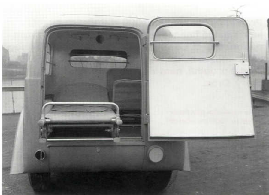
Sanitní prostor vozu Rapid 1500 – zadní dveře byly zavěšené vpravo
