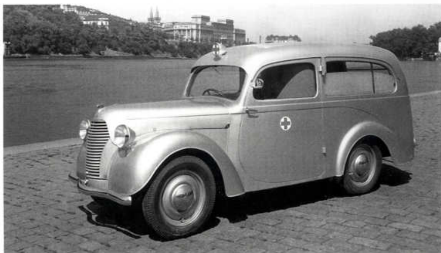
Sanitní „Liduška“ měla rozvor 2,20 m a celkovou délku pouhých 3,85 m První exemplář sanitky Popular 995 měl lehátko umístěné na levé straně
