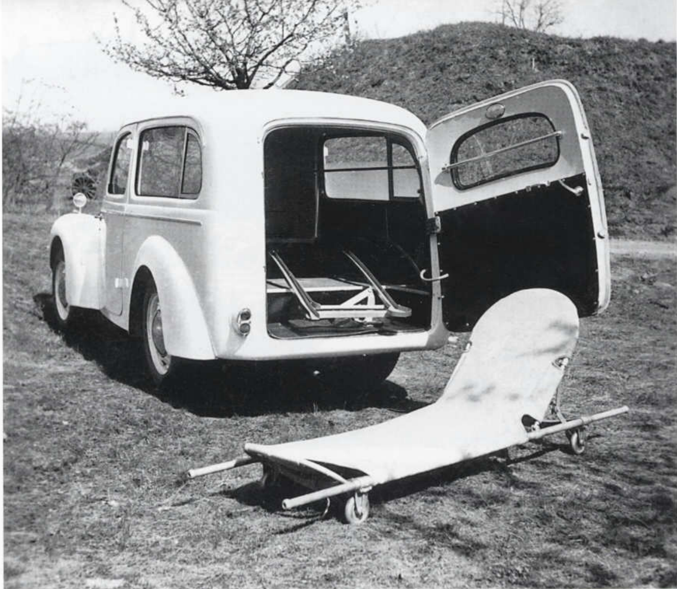
Lůžko mělo pryžová kolečka, uvnitř byl pojezd z profilů U
