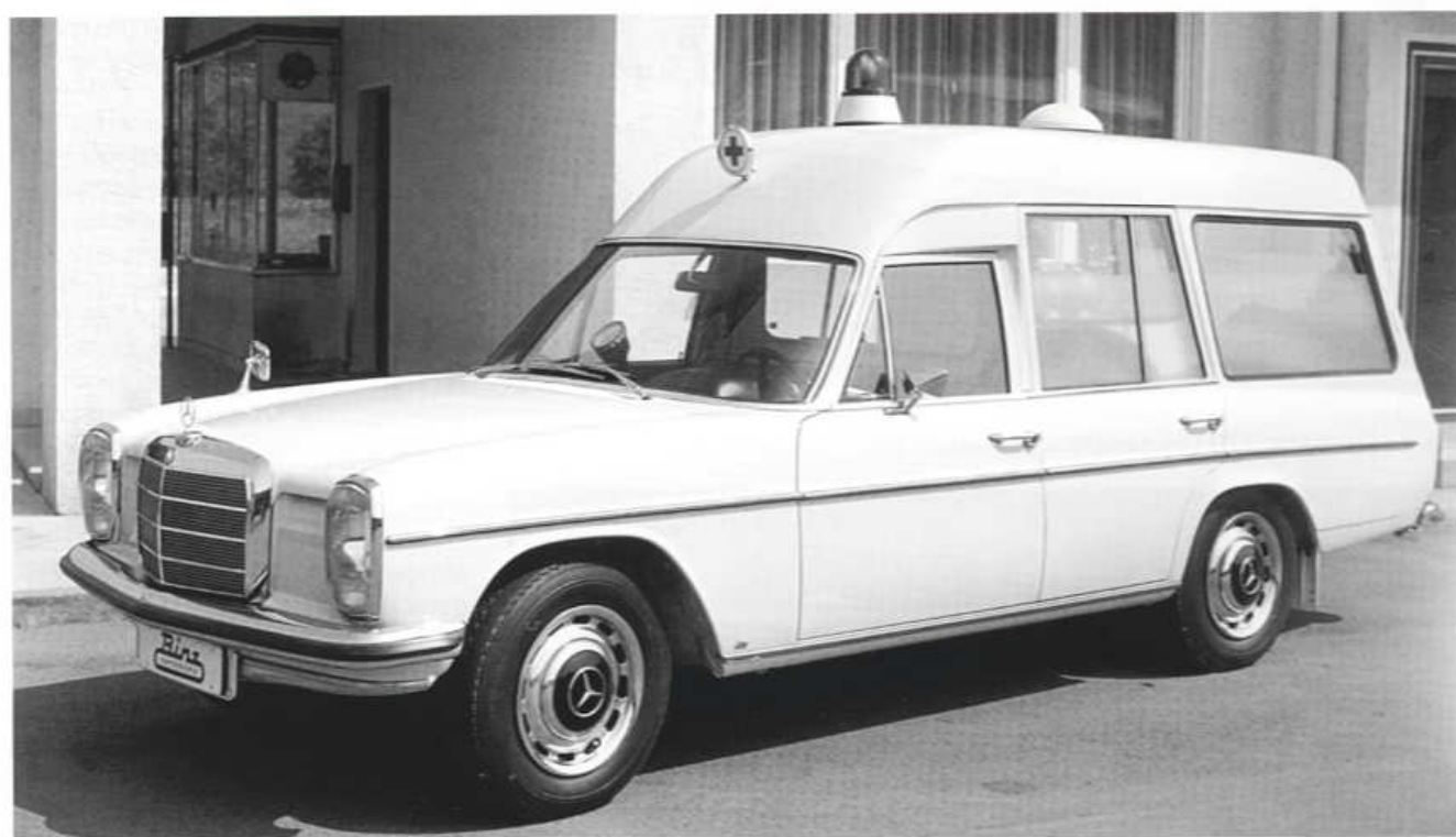
Sanitní Mercedes-Benz 230 se šestiválcem 2,3 l a karoserií Binz (1968)
