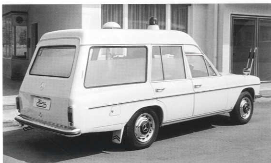
Sanitní Mercedes-Benz 230 se šestiválcem 2,3 l a karoserií Binz (1968)
