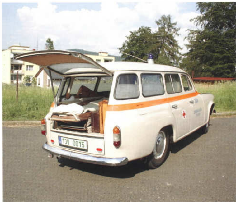
Zadní dveře Škody 1202 se vyklápějí směrem vzhůru
