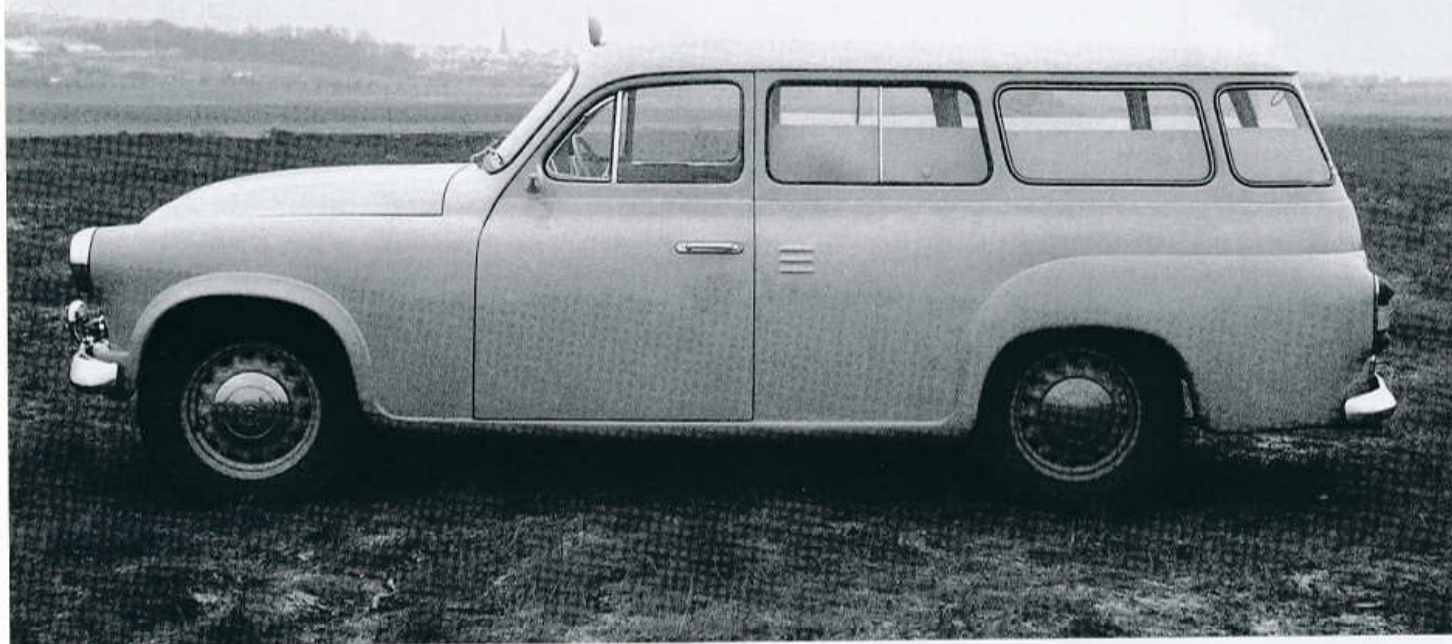
Na levém boku měl prototyp otvory pro přívod vzduchu k topení sanitního prostoru
