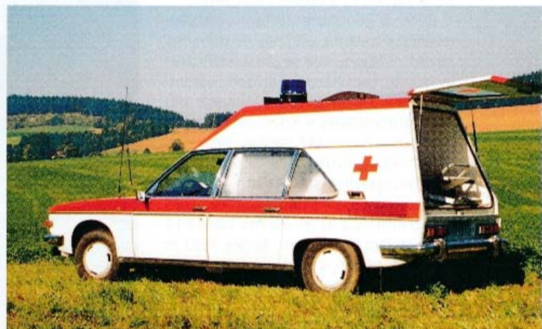
První sanitní Tatra 613 ze Žamberka byla vysoká 1,96 m Vyklápěcí zadní stěna byla opatřena plynovými vzpěrami
