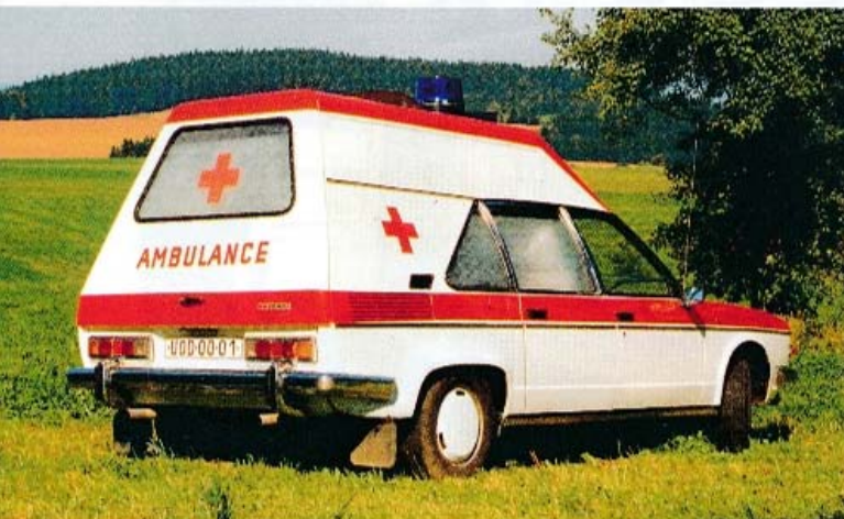
První sanitní Tatra 613 ze Žamberka byla vysoká 1,96 m Vyklápěcí zadní stěna byla opatřena plynovými vzpěrami
