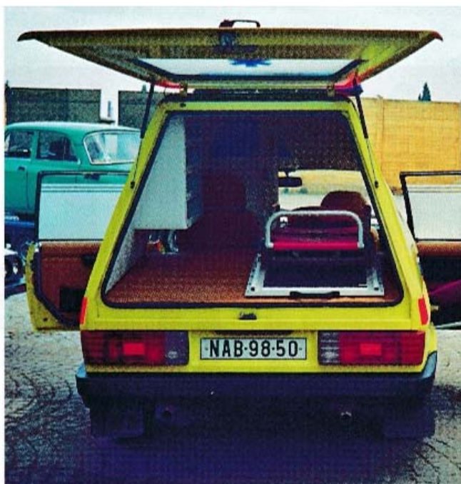
Zadní dveře sanitní T 613 měly práh 0,8 m nad vozovkou
